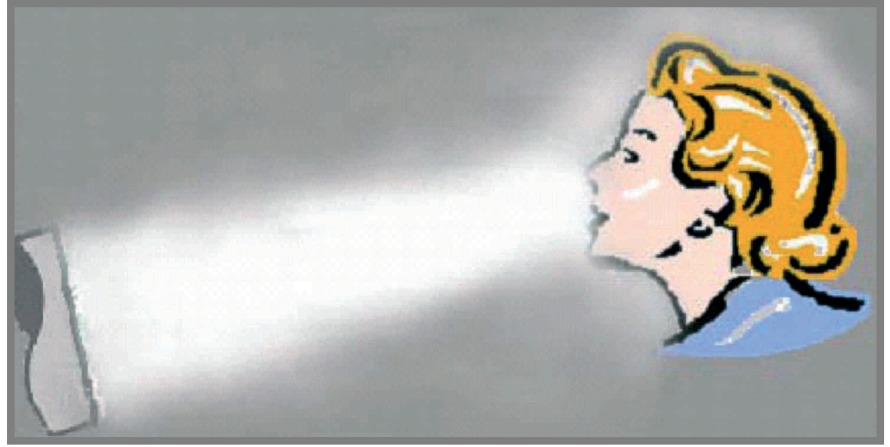
Şekil 1. Kişiselleştirilmiş havalandırmanın temel ikisi: küçük miktarda soğuk, kuru ve temiz havanın bireyin solunum bölgesine doğrudan ve hafifçe beslenmesi ve bu havanın birey tarafından kolayca kontrol edilmesi.
